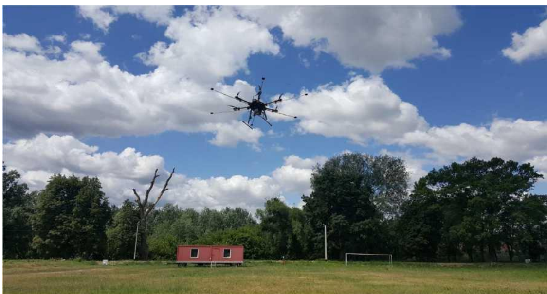
Fot. 9. Bezzałogowy statek latający (UAV) z wysuniętymi ramionami zawierającymi moduły pomiarowe – w trakcie lotu nad poligonem SGSP
