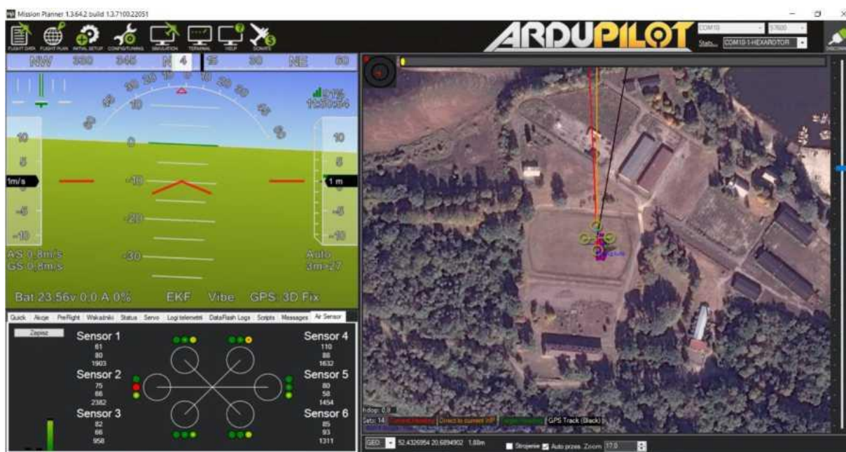
Fot. 10. Okno programu Mission Planer w trakcie lotu nad poligonem SGSP; najwyższe stężenia są rejestrowane na ramieniu UAV z lewej strony
