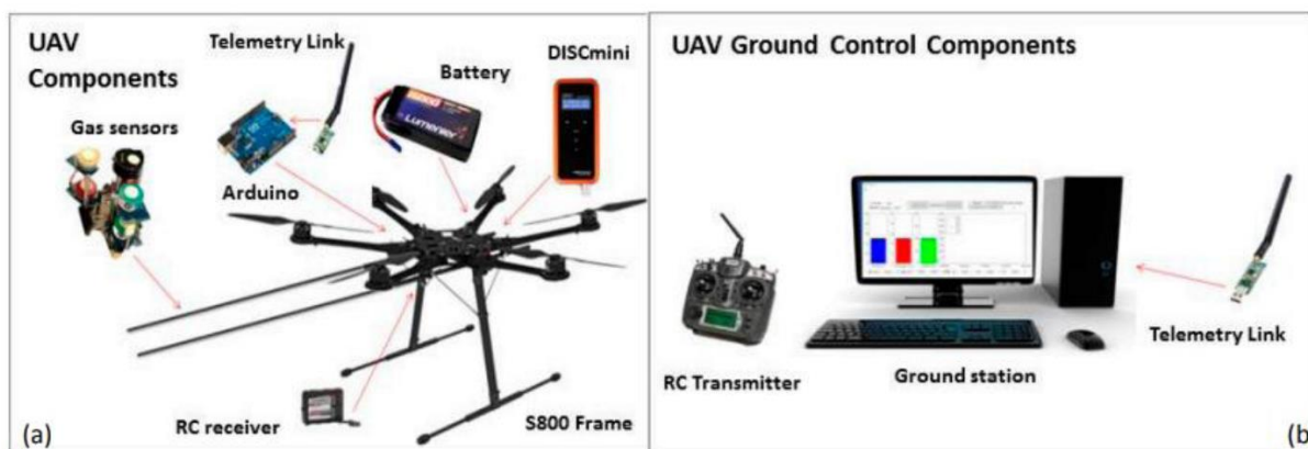
Rys. 1. System pomiarowy wykorzystujący UAV do pomiaru punktowego gazów autorstwa Villa i in.
