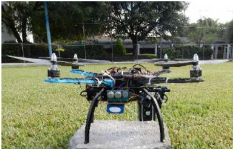
Fot. 5. Dron do pomiaru zanieczyszczeń z zamontowanymi czujnikami autorstwa Noe M. Yungaicela i zespół
