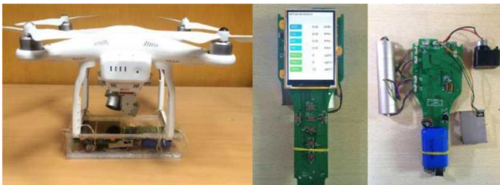
Fot. 6. System pomiarowy zanieczyszczeń powietrza z wykorzystaniem drona autorstwa Yuzhe Yang i in.
