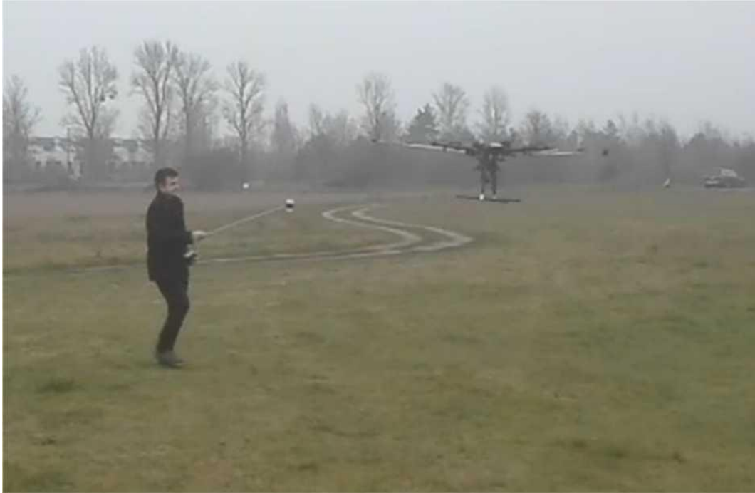
Fot. 13. Automatyczne podążanie UAV za źródłem węglowodorów
