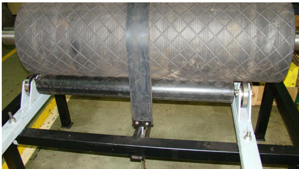
Stanowisko do remontu bębnow (pokazana blokada obrotu)
