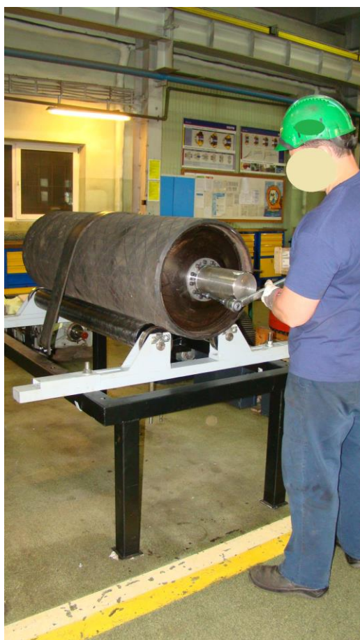
Dokręcanie pierścieni zaciskowych na stanowisku do remontu bębnow (pokazany bęben, rama nośna, podstawa z rolkami, blokada obrotu)
