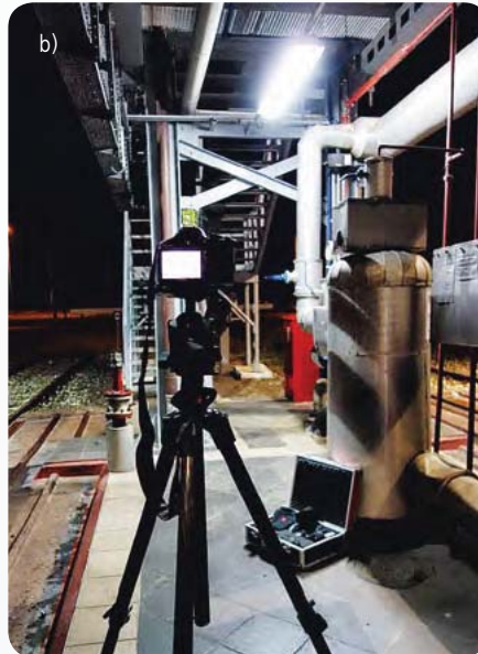
Fot. Widok miejsca pracy, gdzie wykonywany był pomiar wskaźnika oślnienia GR: a) widok obszaru zadania przy cysternach, b) widok fotometru podczas pomiaru
