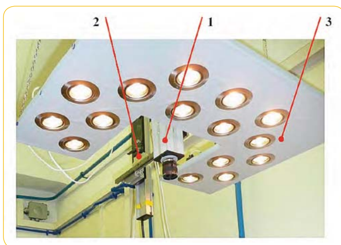
Fot. 4. Kamera i oświetlenie filmowanej powierzchni na stanowisku do badania odrzutu: 1 – kamera szybka; 2 – regulowany uchwyt kamery; 3 – oświetlenie halogenowe
