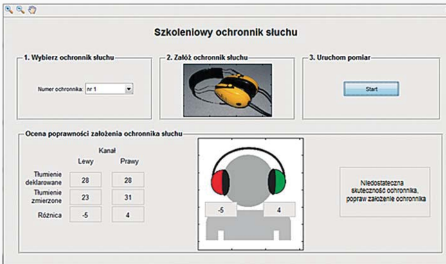
Rys. 7. Widok okna oprogramowania szkoleniowego ochronnika słuchu (oprogramowania sterującego) po przeprowadzeniu pomiaru rzeczywistej skuteczności ochronnika słuchu
