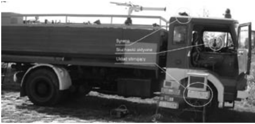
Rys. 2. Widok pojazdu uprzywilejowanego w trakcie pomiarów sygnalizatora dźwiękowego z układem aktywnym redukcji hałasu we wnętrzu pojazdu
