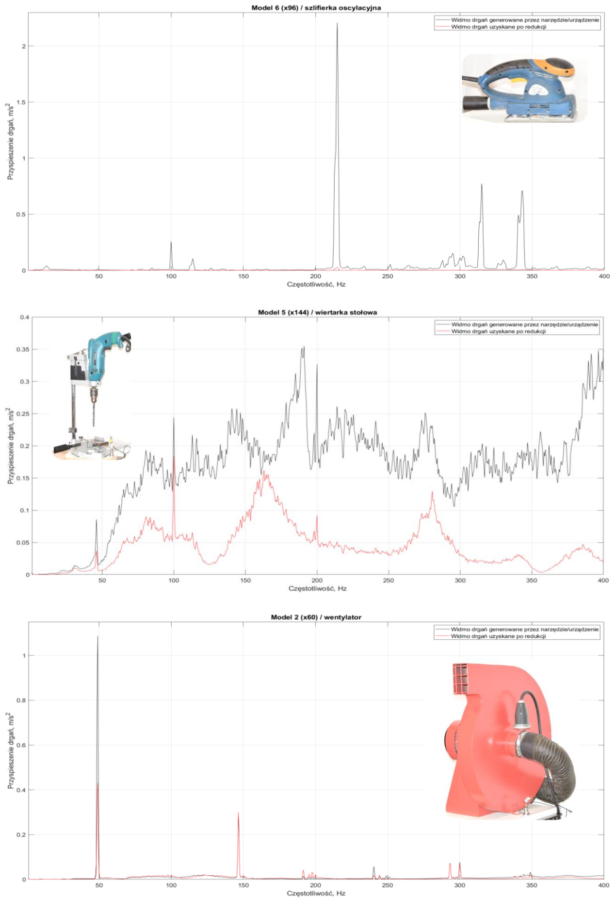
Rys. 3. Widma przyspieszeń drgań źródła drgań oraz po ich redukcji uzyskanej przy pomocy opracowanych ustrojów antywibracyjnych 3D
