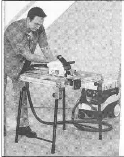
Rys. 2. Stół do prac wykonywanych ręcznymi narzędziami zmechanizowanymi (materiały informacyjne firmy FESTOOL)
