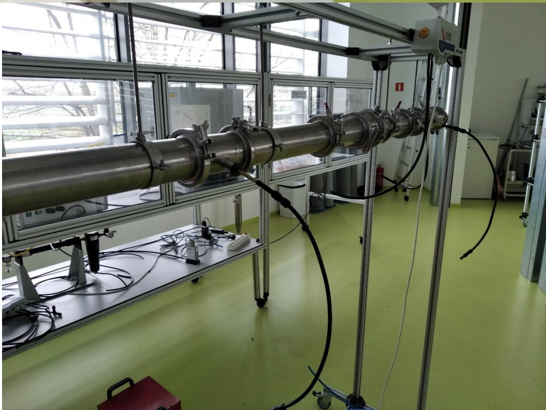
Tri clamp i stanowisko do badania filtrów powietrza
