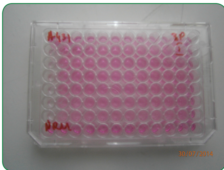
Fot. 3. Wielozagłębieniowa płytko do badań cytotoksyczności na hodowlach komórkowych w warunkach in vitro , fot. CIOP-PIB
