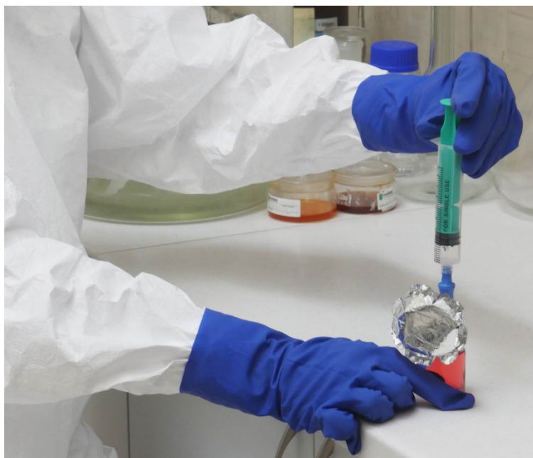
Rys. 7. Przykładowa aparatura analityczna do pobierania leku cytostatycznego z zastosowaniem strzykawki luer-lock (fot. CIOP-PIB)
