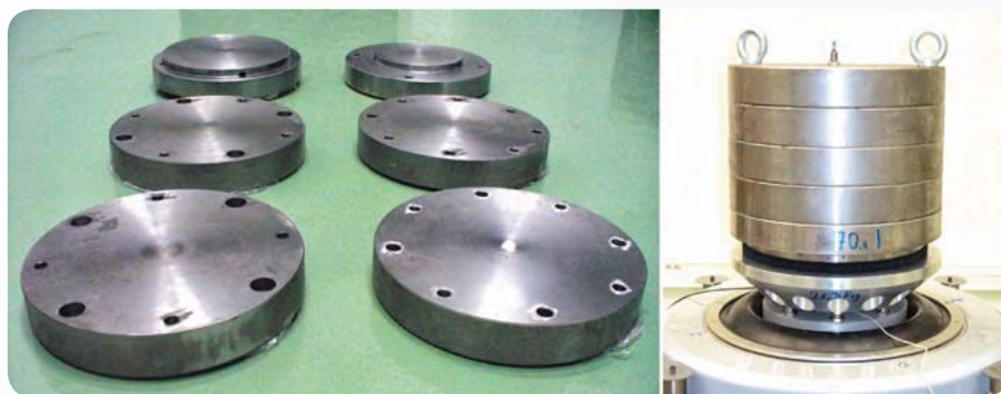
Rys. 2. Sposób obciążania próbek materiałów podczas badań przy użyciu obciążnika testowego o regulowanej masie 70 \pm 350 kg
