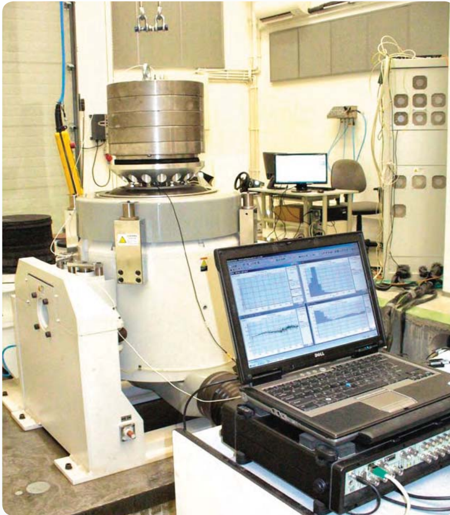
Rys. 3. Stanowisko do badań transmitancji materiałów do ochrony przed drganiami mechanicznymi na stanowiskach pracy Fig. 3. Sample of tested material during measurement
