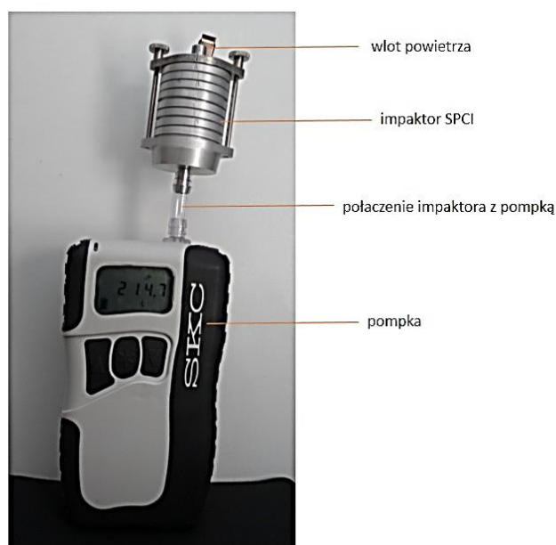
Rys. 5. Zestaw pomiarowy impaktor SPCI ( sioutas personal cascade impactor ) połączony z pompką
