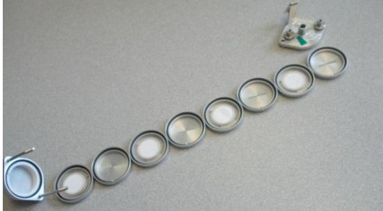
Rys. 7. Próbnik typu PCIS wraz z filtrami przed pobraniem próbek frakcji stałych aerozoli wysokotemperaturowych
