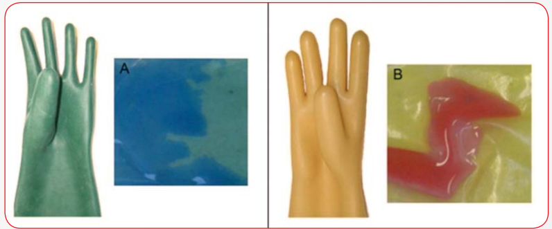
Fot. 3. Efekt uszkodzenia rękawic w kontakcie z zasadą: (A) – wybarwienie w kolorze niebieskim oraz kwasem (B) – wybarwienie w kolorze purpurowym
