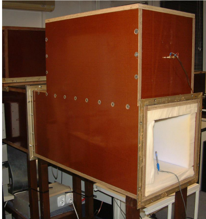
Rys. 10. Falowód akustyczny do badań systemów aktywnej redukcji hałasu.
